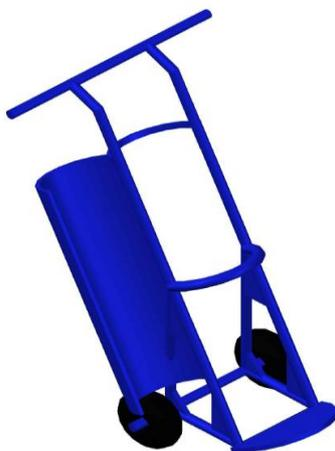
图 8.2-11 气瓶防晒车示意图
