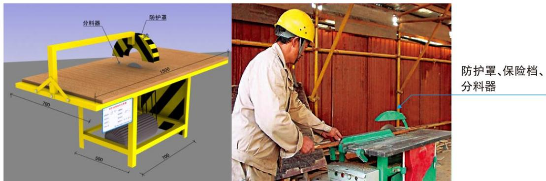
图 8.2-13 切割机防护罩
