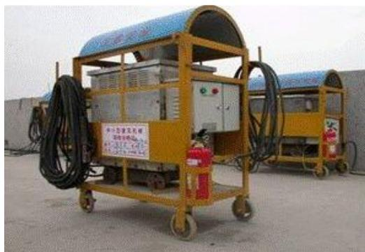
图 8.2-8 电焊机防晒防雨车
