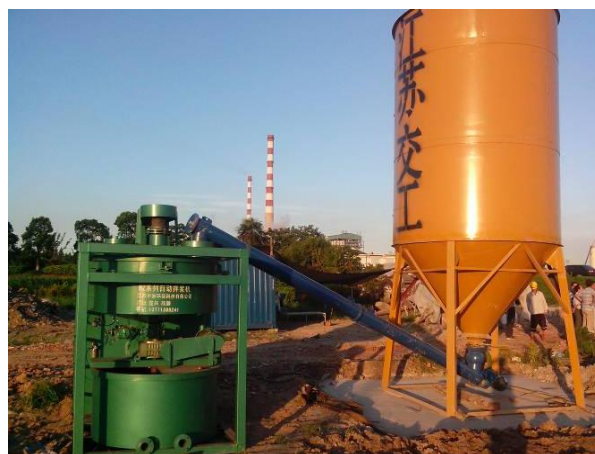
图 4.1-4 自动数控高速搅拌机
