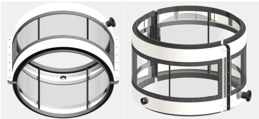
图9.4.3-6 可视化主缆表面观察窗构造示意图
