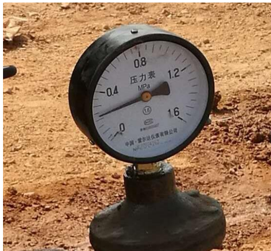
图 2.2-5 三重管法施工浆压值
