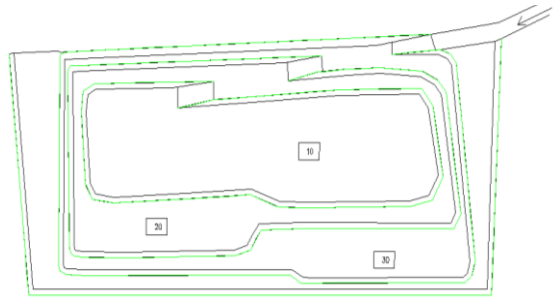
图 3.1-9 基坑直进式道路布置示意图
