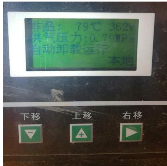
图 2.2-4 三重管法施工风压值
