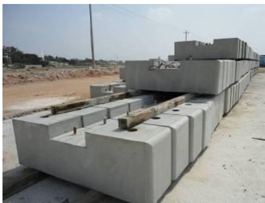
图 2.2-4 轨枕无棱角化预制
