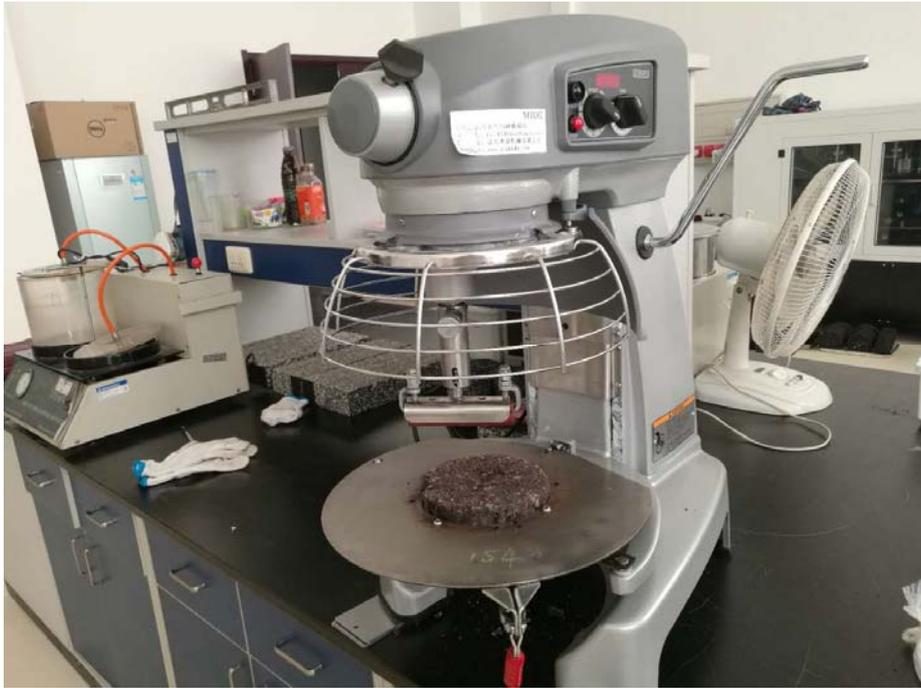
图 6 乳化沥青冷再生混合料磨耗试验
