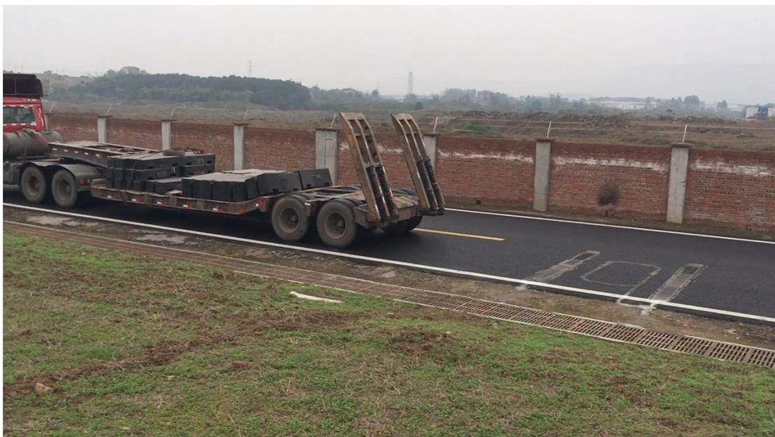
图 4 非刚性车（五轴铰接挂车）动态试验
