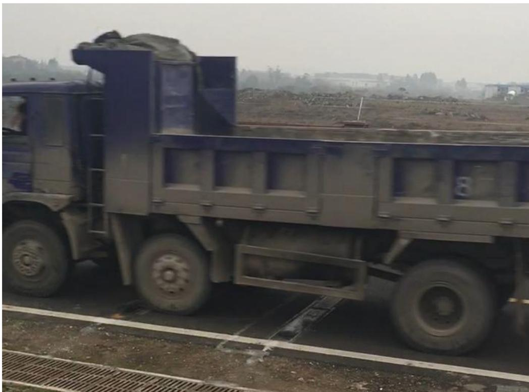
图 3 非两轴刚性车（三轴刚性货车）动态试验
