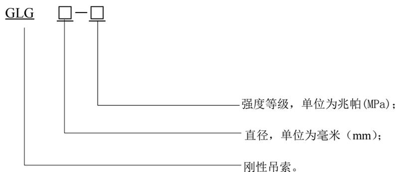
图11 刚性吊索型号表示方法
