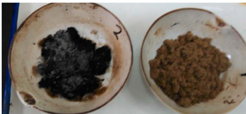
图 3 纤维耐热性试验中纤维燃烧情况
