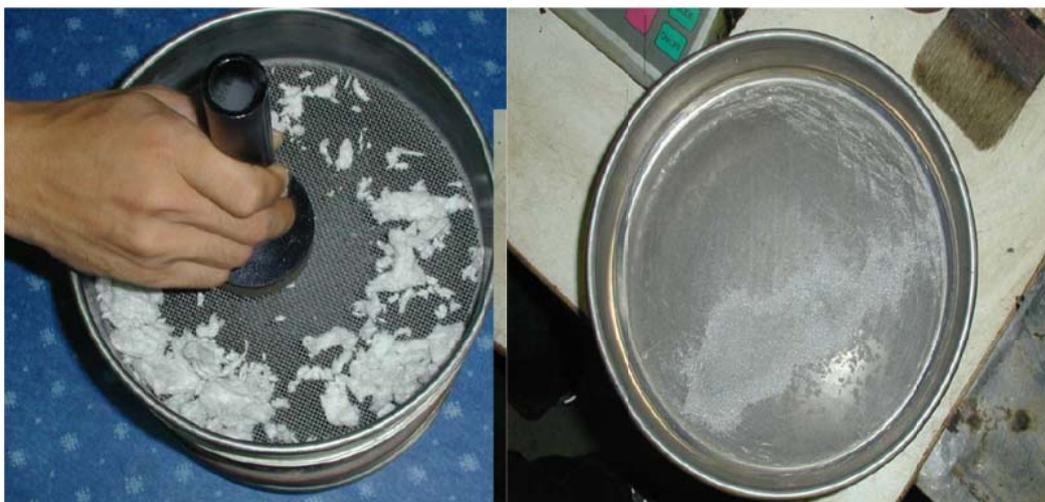
图5 研磨、剔除纤维后筛分测定渣球含量
