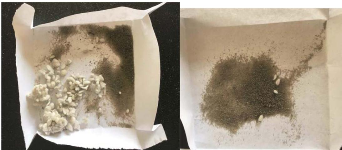
冲气筛后纤维和渣球 人工处理后渣球
