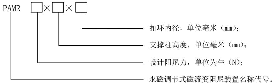
图3 永磁调节式磁流变阻尼装置型号表示方法
