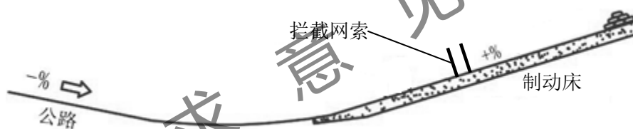
图 7.1.2 网索-阻尼系统设置示意图
