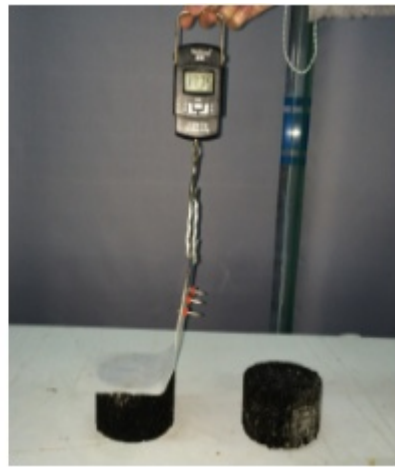
1 沥青混凝土试件；2 聚酯毡；3 夹具；4 螺栓及螺母组合件；5 数显测力计
