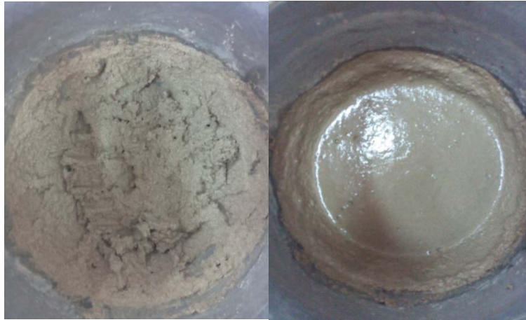
图 2 加入少量高效减水剂的涂料浆图 3 加入过量高效减水剂的涂料浆
